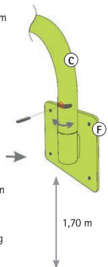
8. Stecken Sie den Metallbogen (C) bis zur Aussparung in die Wandbefestigungsplatte und drehen Sie die Madenschraube mit dem Inbusschlüssel fest.
